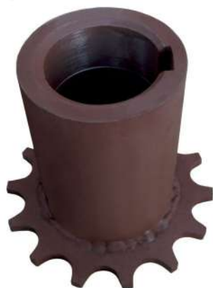
Полумуфта ПР 01.00.120А (Закаленная, цементация 42-45HRS) .....
