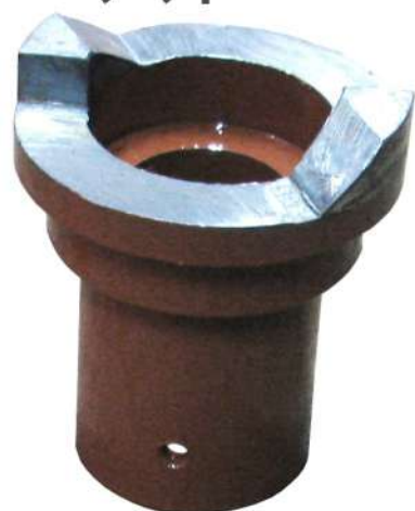
Полумуфта ПР 01.00.100А (Закаленная, цементация 42-45HRS) .....
